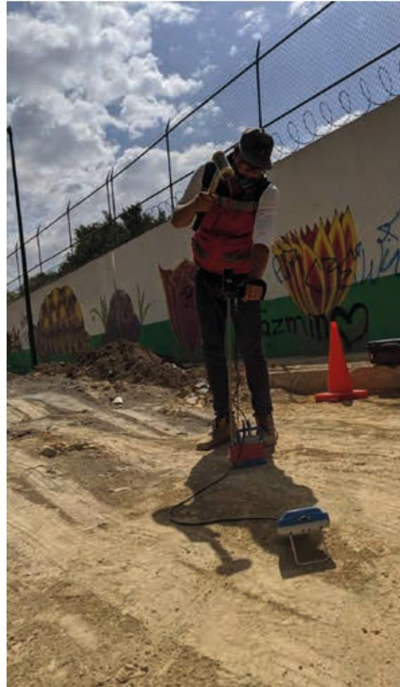
**Figura 20. Sondeos geotécnicos tipo PANDA para conocer la resistencia del suelo 2021**
