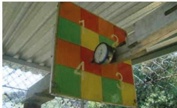
**Figura 11. Estación de Monitoreo de Deformación Superficial ubicada en el Deportivo La Cascada. 2015**
