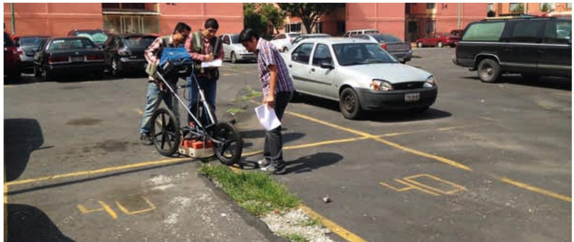
**Figura 15. Estudio mediante método geofísico para análisis de subsuelo en U.H. Albarradas, CERG 2014**
